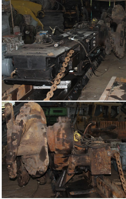
Fig. 11. Montarea combinei pe transportor [3]
