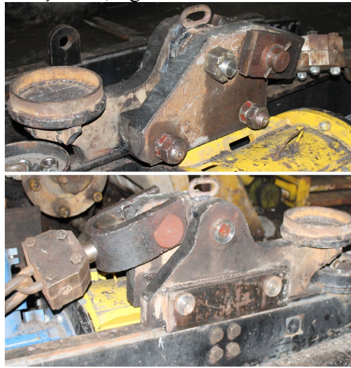
Fig. 5. Sistemul de legare a lanțului la stația de acționare executat la E.M. Lonea [3]
